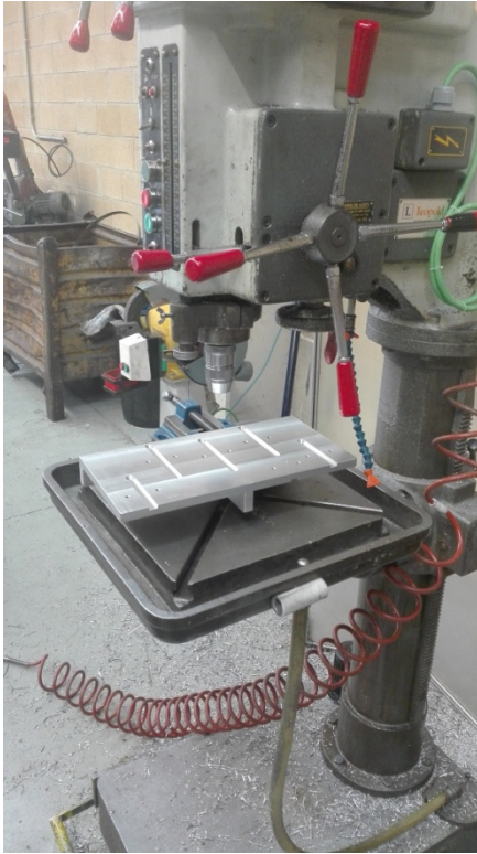
Ilustración 22. Placa taladrada en taladro vertical.
