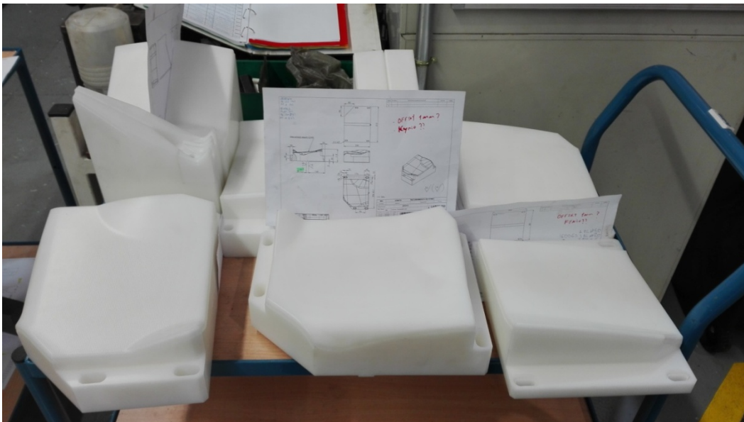
Ilustración 23. Piezas con superficies CAM.
