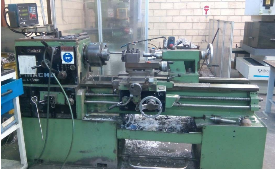
Ilustración 9. Torno manual "Pinacho L1-260"
