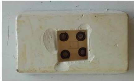
Ilustración 68: Molde de Hormigón polímero
