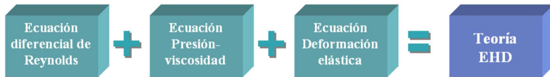
Ilustración 27: Ecuaciones del problema elastohidrodinámico (EHD)
