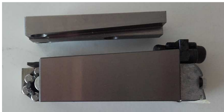
Ilustración 38: Patín de rodadura sin una de las tapas laterales
