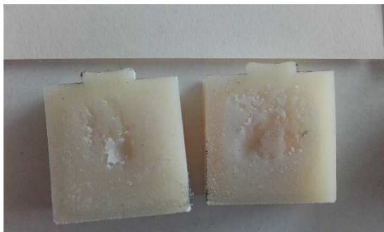
Ilustración 86: Pastilla sinterizada (blanda en el interior)
