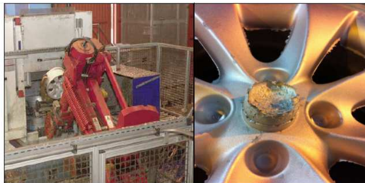
Figura 2.11: Robot de la célula de desmazarotado colocando la llanta en la máquina detaladro (izquierda) y la mazarota de llanta de aleación de aluminio(derecha).
