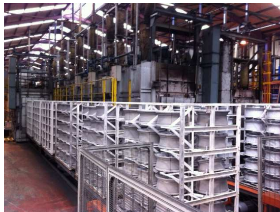
Figura 2.12: Las llantas se introducen en los hornos para ser tratadas térmicamente.
