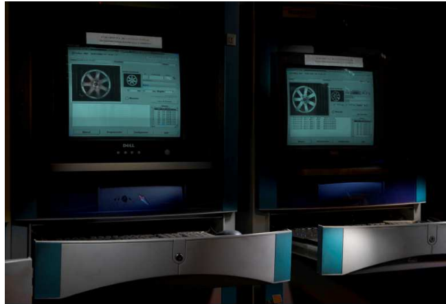
Figura 2.15: Visiones artificiales de las equilibradoras.
