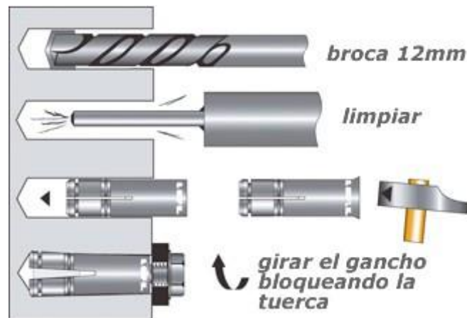
Figura 39. Ejemplo de colocación de un taco en una pared.
