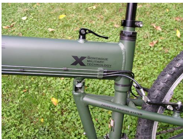
Figura 36 Detalle del cierre de Montague.
