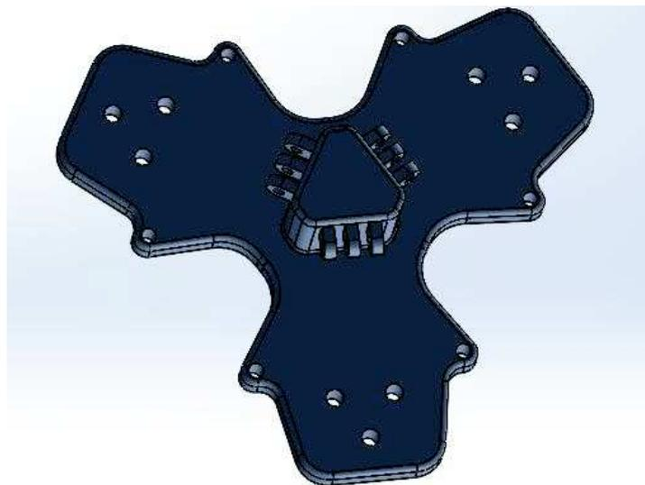
*Fig. 56. Base del rotor*
