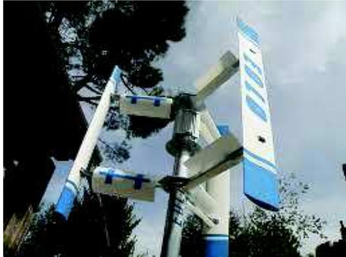
*Fig. 15. Rotor Darrieus de palas rectas*
