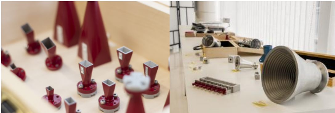
Figura 8 – Ejemplos de Antenas de Bocina en Guía Circular y Rectangular
