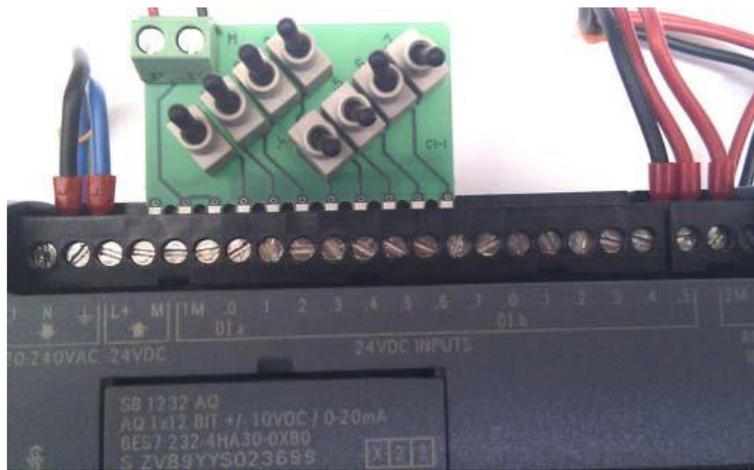
**Figura 45.** PLC Siemens, placa de simulación.
