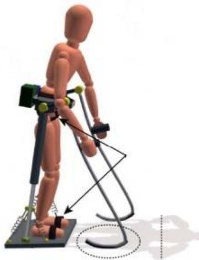
**Figura 22.** Mecanismo de 8 barras. (SciELO, 2015)
