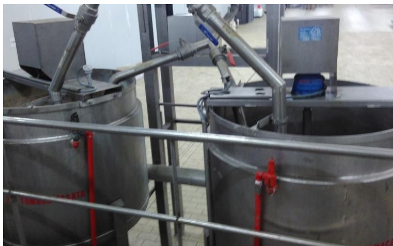
Figura 25: Cubos de composición de tomaca. Los motores en la parte superior accionan los agitadores
