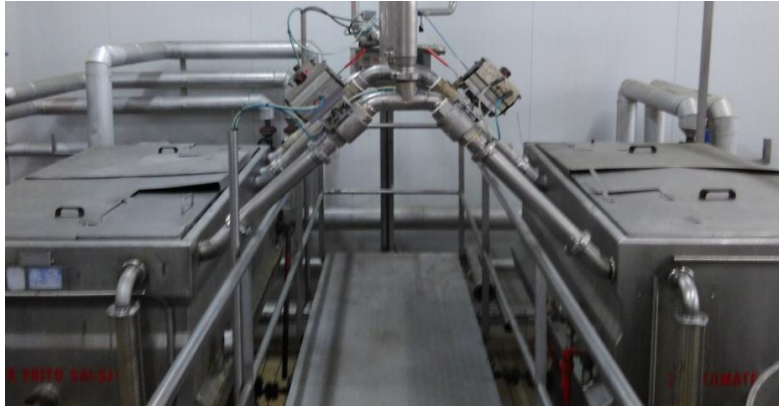
Figura 24: Balsas de composición de tomate frito. Las tuberías las alimentan de zumo e ingredientes necesarios para la composición.
