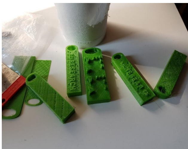
Figuras 109 y 110: Impresora 3D creando uno de estos llaveros. A la derecha aparecen algunos de los llaveros realizados con PLA que salieron defectuosos.
