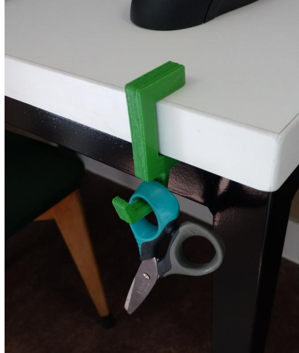
Figuras 52 y 53: Impresora 3D del centro. En la segunda imagen se muestra “el guarda tijeras”, elemento realizado con impresión 3D que permitía que las tijeras colgasen y el alumno las tuviera siempre a mano, evitando incidentes y pérdida de material.
