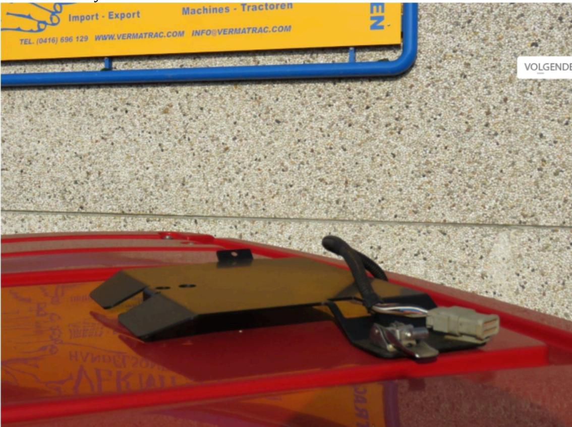
Detalle de la instalación para el montaje de GPS (AFS)
