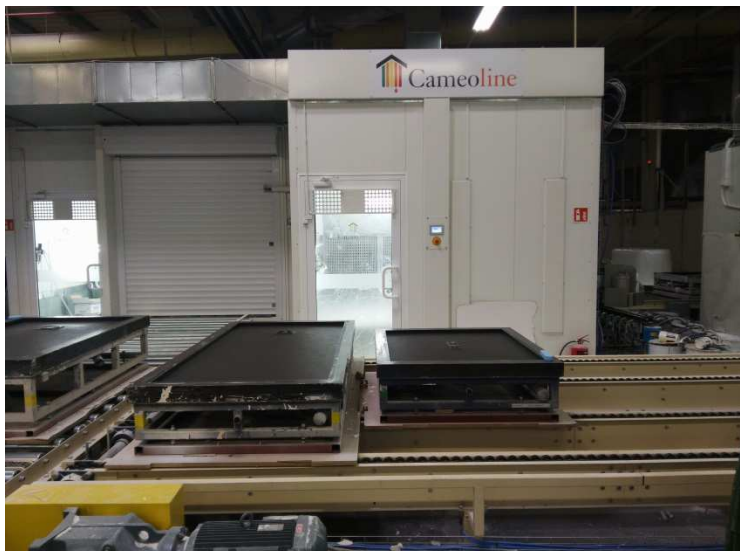
Figura 18. A la derecha se puede observar la cabina de pintado y a la izquierda la cabina de secado
