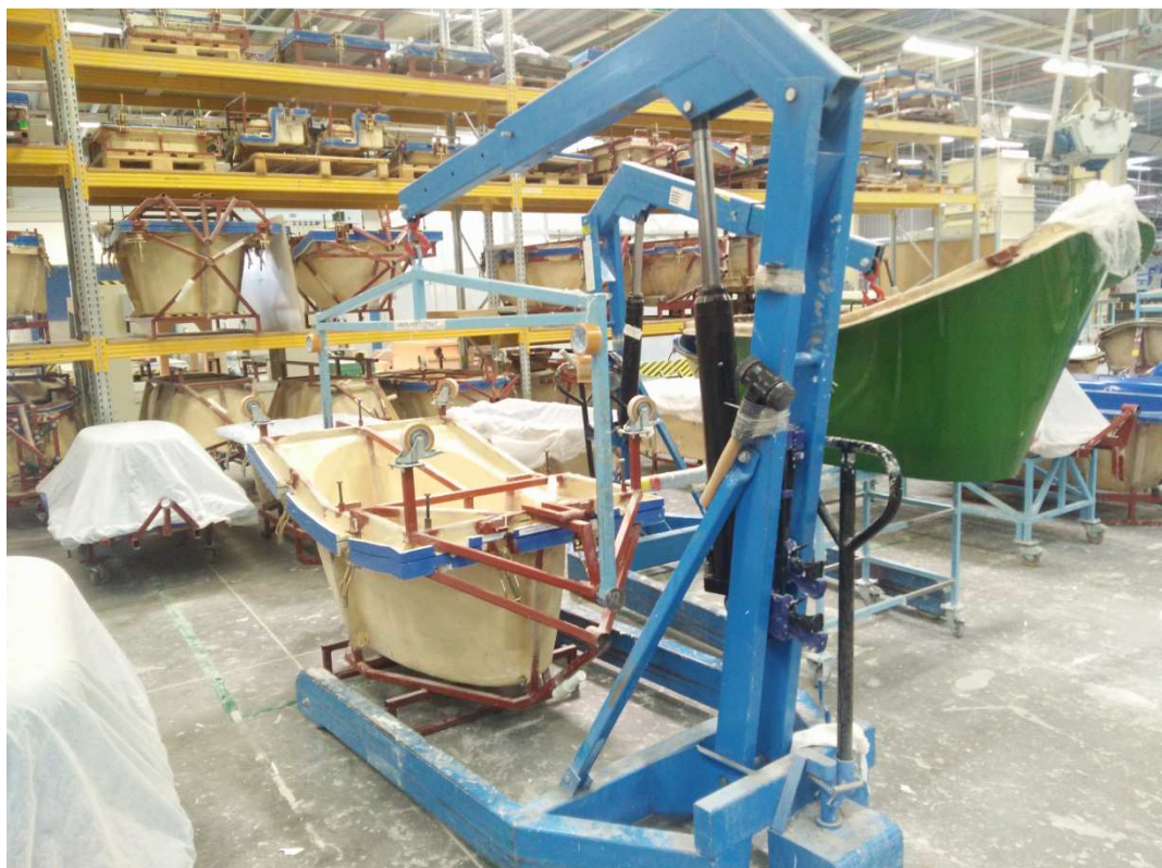
Figura 19. Montaje y desmoldeo de una bañera con el uso de una grúa.
