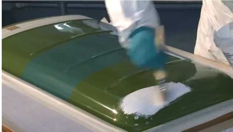
Figura 12. Aplicacion de gel-coat
