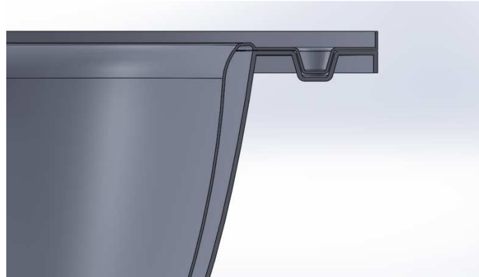
Figura 54. Vista en sección de cómo deberían encajar los dos cilindros de la Forma A y la Forma B
