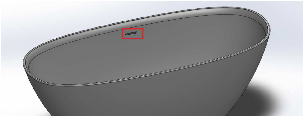
Figura 71. En rojo esta la posición en la que ira el inserto que luego hará de overflow una vez se quite el inserto
