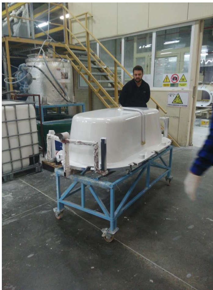
Figura 44. Forma A de la bañera Wanna Gelcotowak, a la que se le ha dado una capa de Gel-coat, y a la que se le ha instalado los insertos y tubos para practicarle la cavidad del overflow.
