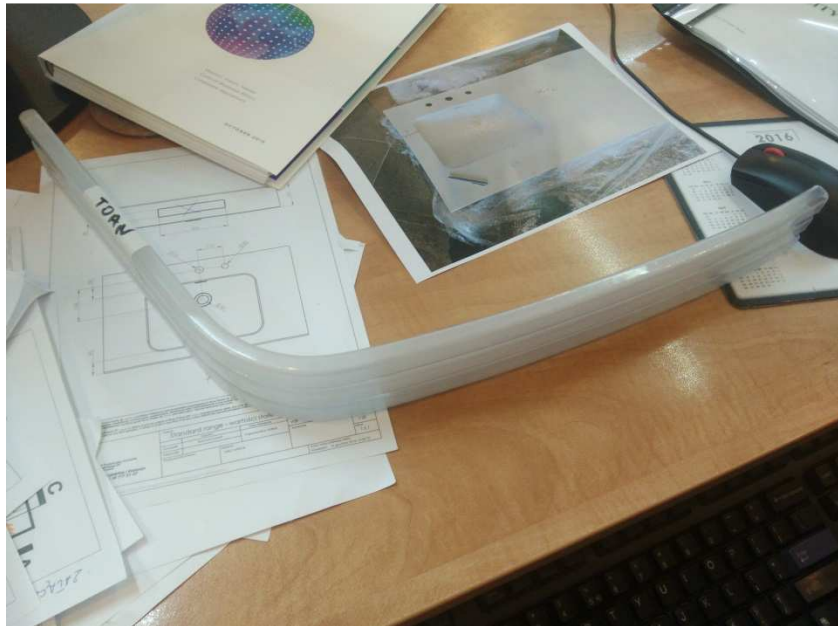
Figura 13. Tubos para el overflow
