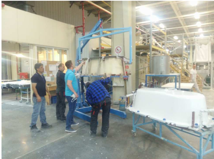
Figura 6. Montaje de los moldes de la bañera Wanna Gelcotowak
