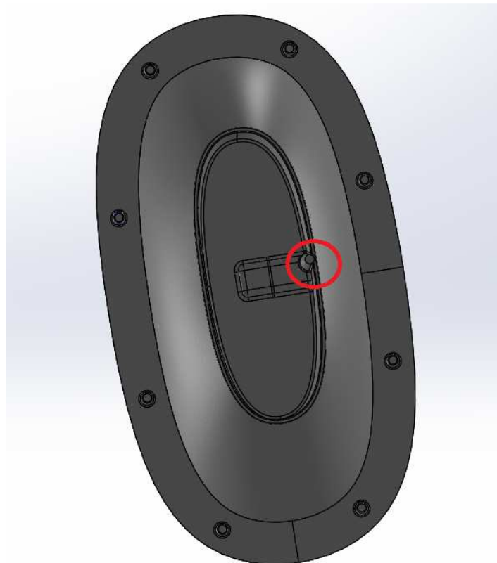
Figura 40. Marcado en rojo se tiene el punto de inyección que va en la parte baja de la bañera
