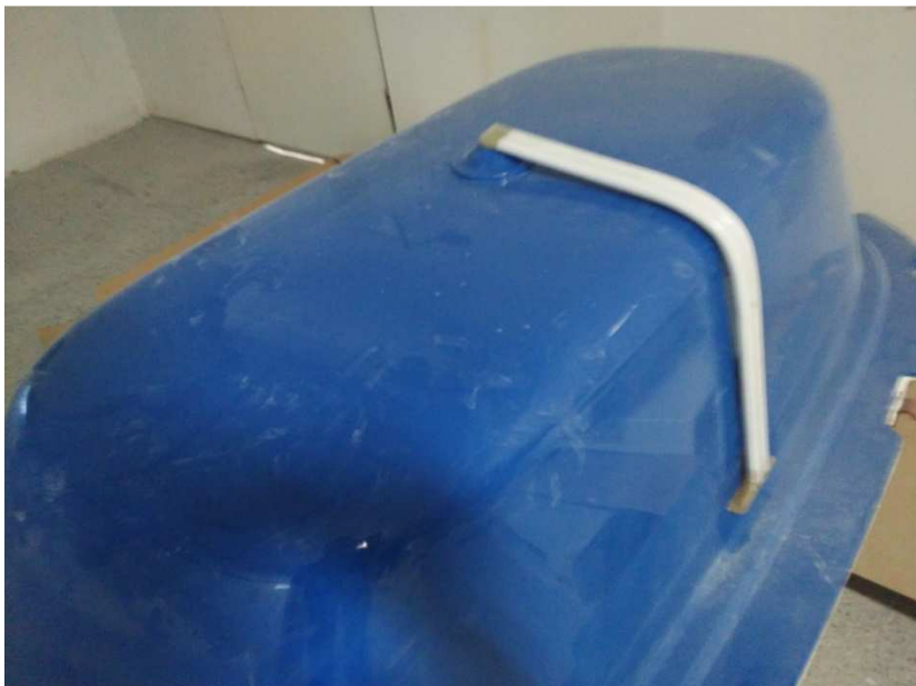
Figura 15. Imagen de un overflow instalado en un molde con sus insertos y relleno de sal
