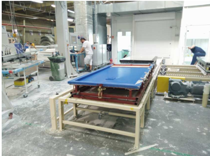
Figura 17. Entrada de los moldes a la línea de producción.
