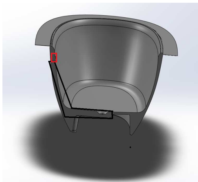
Figura 65. Vista en sección de dónde iría instalado el overflow en la bañera. En negro irían los tres tubos y en rojo es donde iría instalado el inserto de silicona
