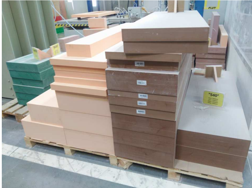
Figura 11. Bloques de poliestireno que se deben unir
