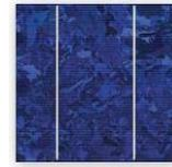
Figura 4: Célula de silicio policristalino
