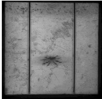
*Figura 70: electroluminiscencia del laminado 46.0116.0-27 tras un impacto de granizo*
