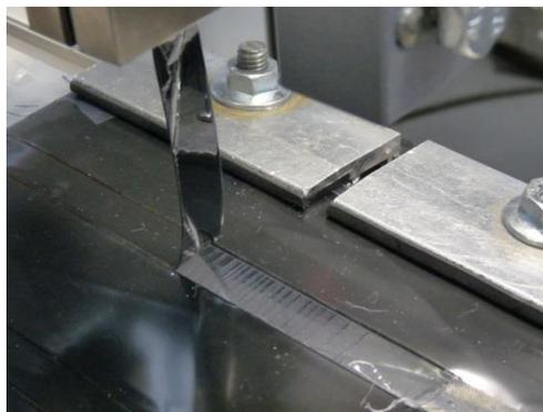
*Figura 44: Mordaza tirando de la pestaña verticalmente durante el test de pelado*
