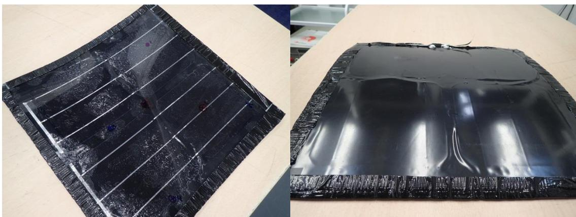
Figura 61: Módulo 46.0116.0-56 con claras delaminaciones frontales y traseras.
