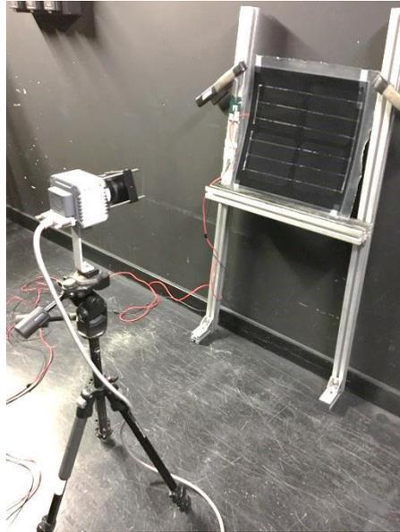
*Figura 47: Vista del montaje para el ensayo de electroluminiscencia.*
