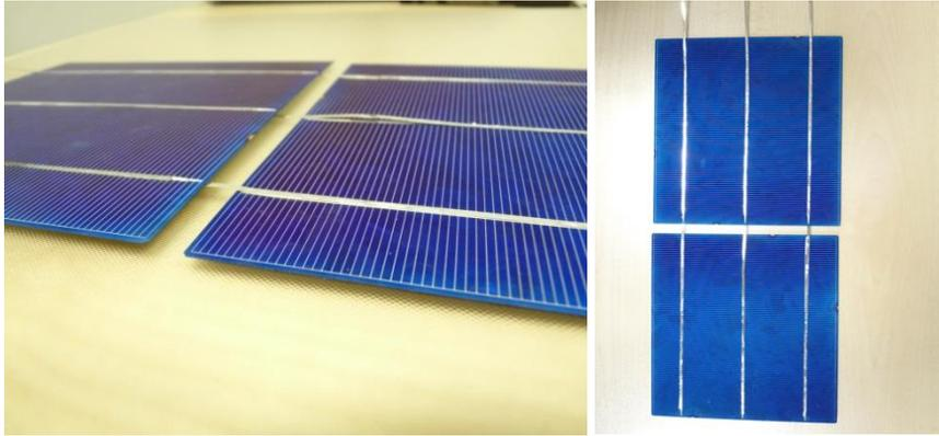
*Figura 36: Unión mediante ribbon de dos célula*
