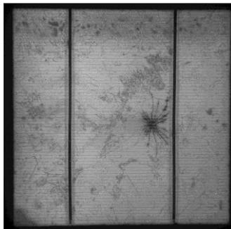
*Figura 67: electroluminiscencia del laminado 46.0116.0-28.*
