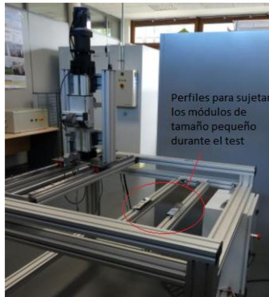
*Figura 41: Estructura de soporte del módulo*
