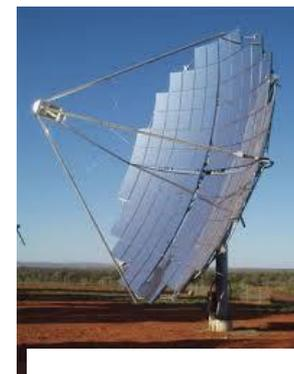
Figura 10: Módulo de concentración FV
