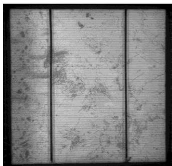
Figura 74: electroluminiscencia del laminado 46.0116.0-29 tras un impacto de granizo
