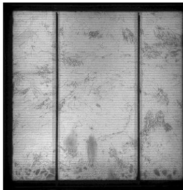
*Figura 71: electroluminiscencia del laminado 46.0116.0-58*
