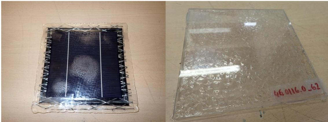
Figura 62: Laminados 46.0116.0-32 y 46.0116.0-62 con delaminaciones.
