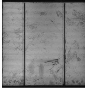
*Figura 72: electroluminiscencia del laminado 46.0116.0-58 tras un impacto de granizo*
