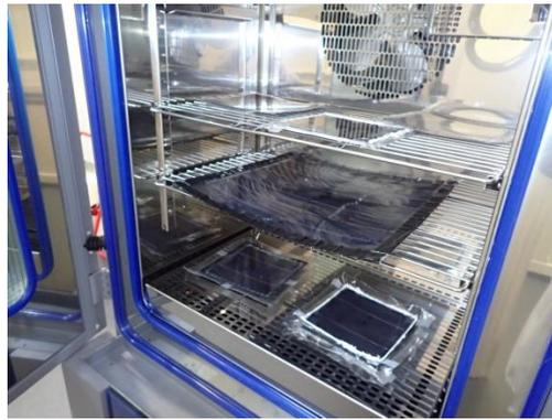
Figura 60: Cámara de ensayo de calor húmedo con muestras.
