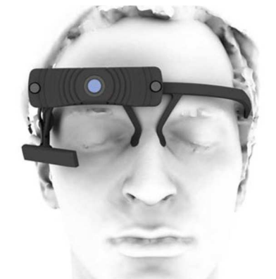
Figura 4. Dispositivo de eye tracking PUPIL de bajo coste y código abierto
