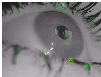
Figura 48 Imagen del sujeto número 22 con el mapa de votaciones obtenido mediante la FRST superpuesta en verde y en rojo el centro estimado.
