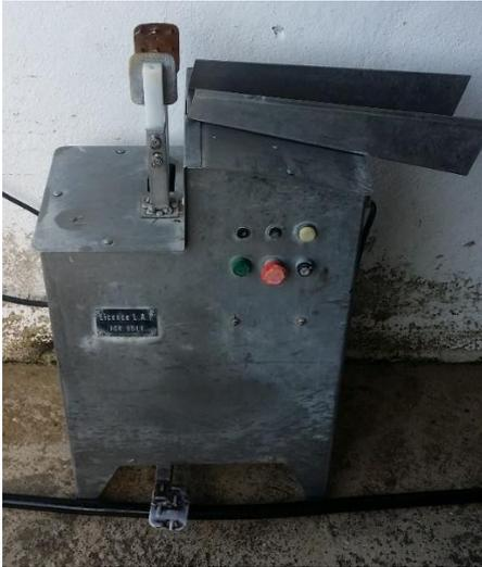
*Ilustración 6. Máquina de electroanestesia para el sacrificio de conejos*
