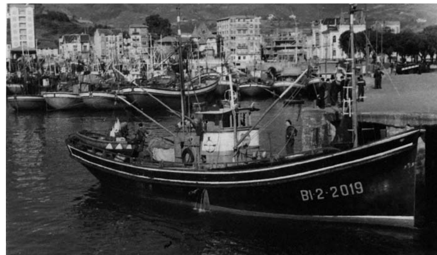
Imagen n° 6. "El Reinaras", construido en Lekeitio en 1951, con 17 m de eslora, 41 toneladas y un motor de 100 CV, es de características similares a las del Ben Hur. Archivo de Juan Antonio Apraiz.
