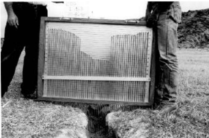
*Figura 2.8.- Perfilador para la medición de las secciones transversales de cárcavas.*
