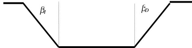
Figura III.2.- Ángulos de los taludes
