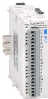
Figura 32 Módulo adicional de entradas PLC (Fuente [7])
