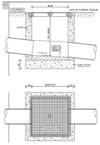
Arqueta de arranque no sifónica para  $\varnothing < 250$  mm
