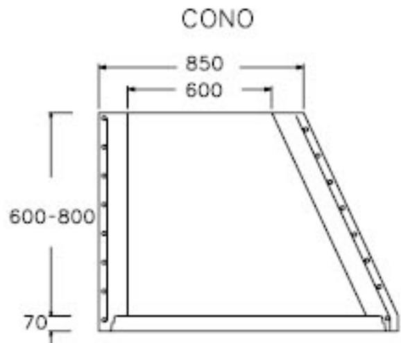
MODULOS DE ALTURA VARIABLE ENTRE 250+1000mm.
