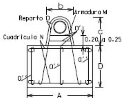
Codos de 90° y TES, poniendo el anclaje definido por el  $\emptyset$  de la derivación
