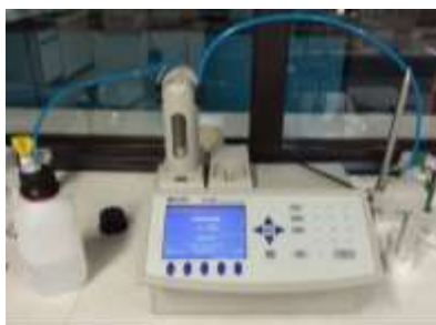
Figura 11. Sistema de titulación HI901C1 Potentiometric Titrator, a la izquierda se encuentra el reactivo de NaOH 0,1 N y a la derecha la muestra con el sensor de temperatura, el electrodo de pH y el agitador.
