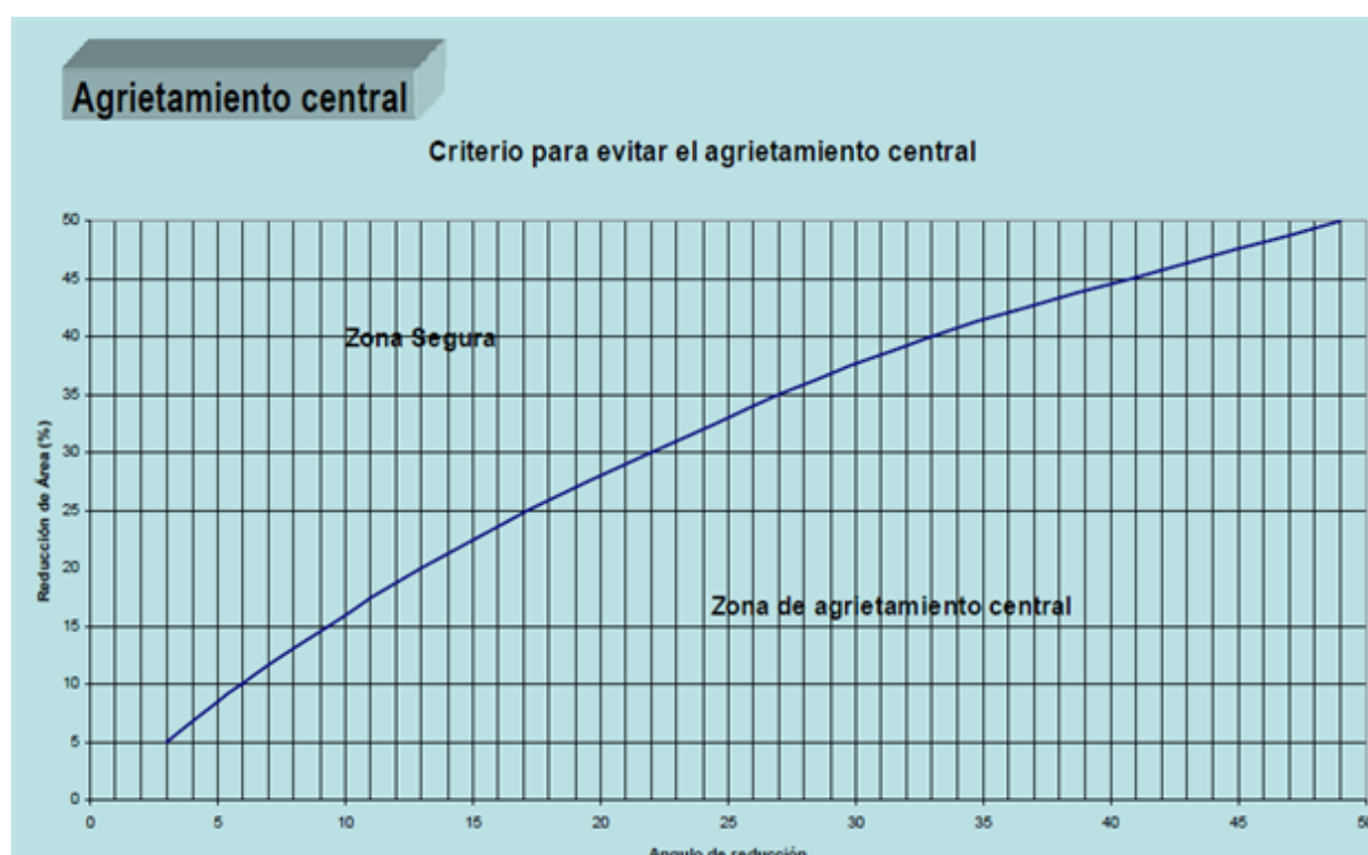
Imagen 33: Criterio agrietamiento central
