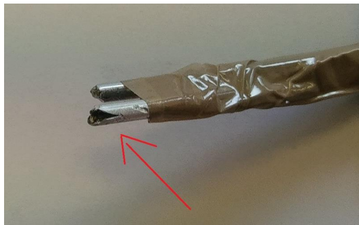
Imagen 3: Rotura fisura en alambre, Cabelte Incasa
