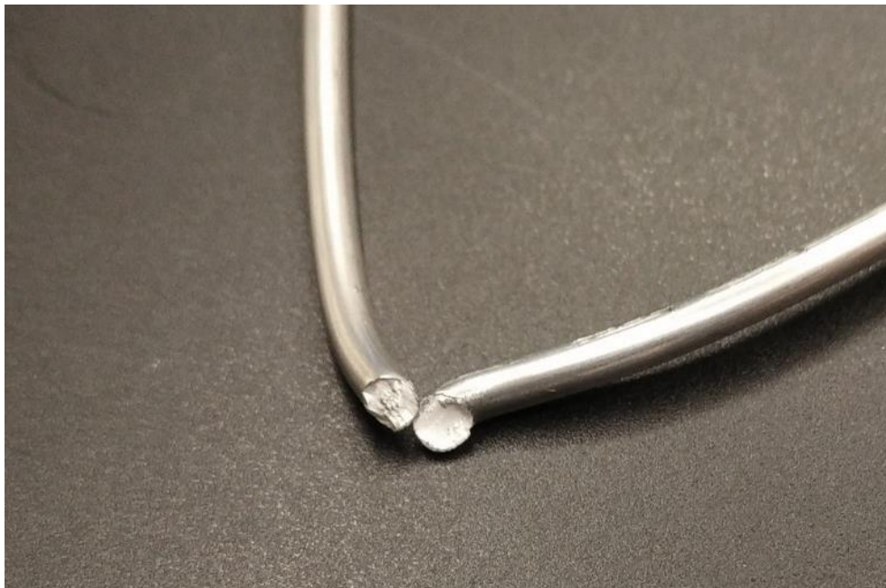
Imagen 11: Rotura por cristalización, Cabelte Incasa
