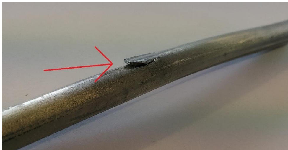
Imagen 6: Desgarro superficial, Cabelte Incasa
