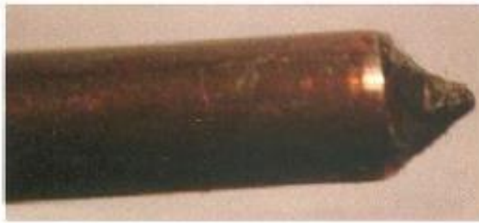
Imagen 14: Rotura copa y cono
