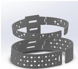
*Ilustración 66: Aro superior e inferior con el sistema de bisagras y los orificios para el velcro.*
