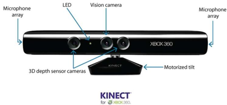
**Figura 4.** Dispositivo Kinect con sensores.
