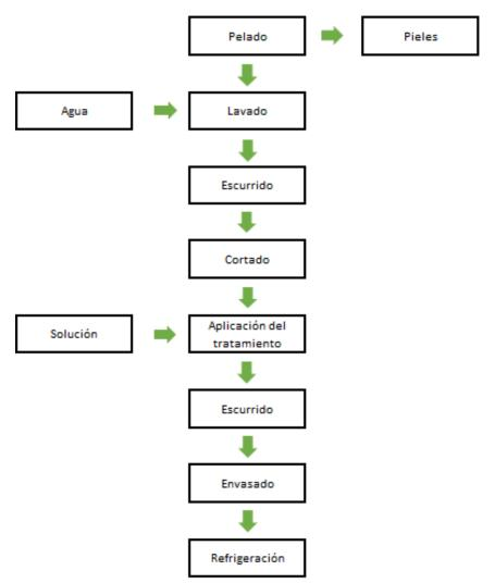
Figura 8. Diagrama de flujo del proceso de la patata mínimamente procesada.
