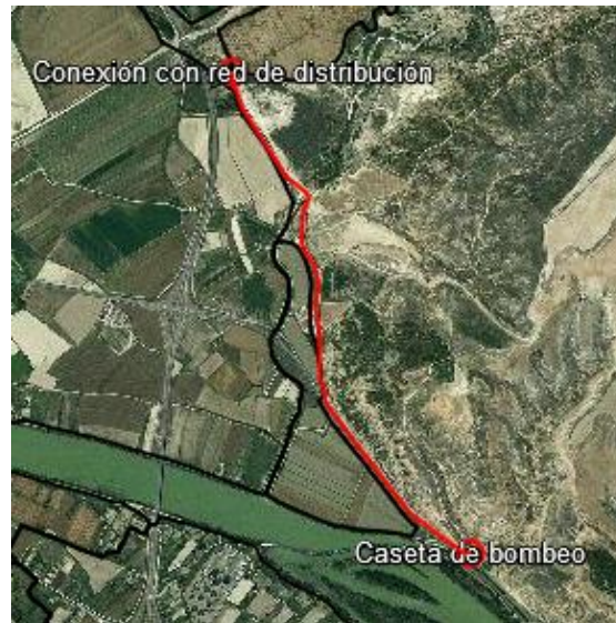
Figura 25: Esquema del trazado de la tubería de impulsión en el escenario sin balsa (elaboración propia)
