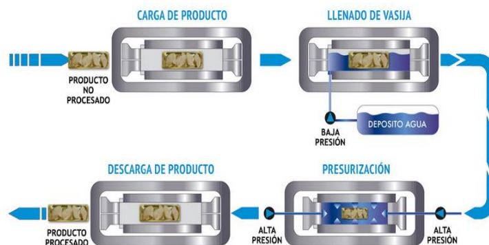
Figura 4. Esquema de funcionamiento HHP (Hiperbaric, 2018)
