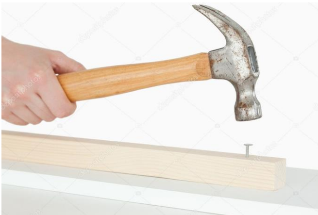
Figura 5. Energía mecánica (cinética) de la mano al martillo y al clavo (potencial)- energía térmica por fricción. varios
