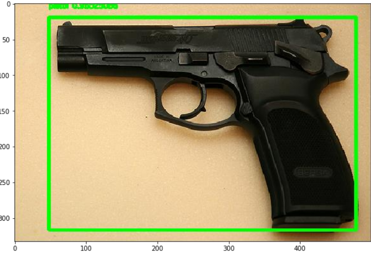
Figura 62, ejemplo 1 detección con Yolo v2 (factor de confianza de 0.99)
