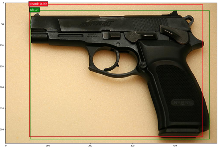
Figura 61, ejemplo 1 detección con ssd300
