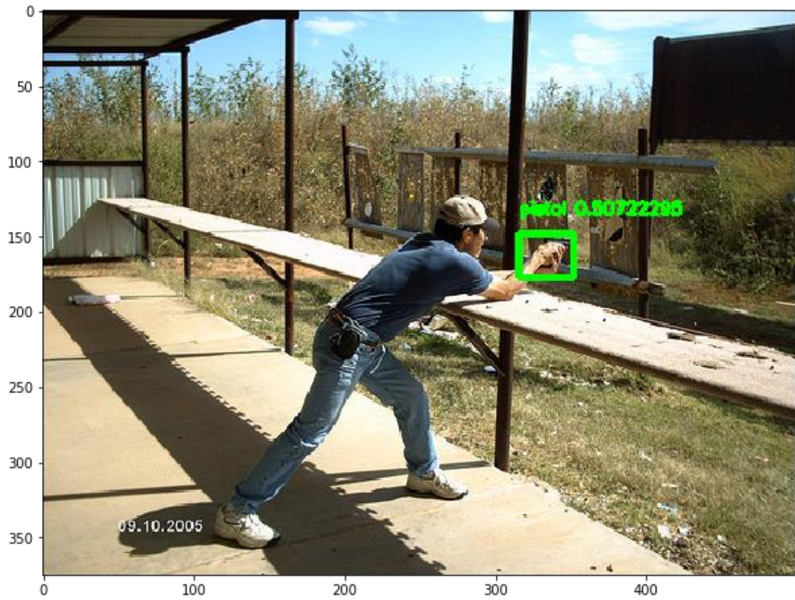
Figura 68, ejemplo de arma detectada en Yolo v2 que no se detecta con el ssd300
