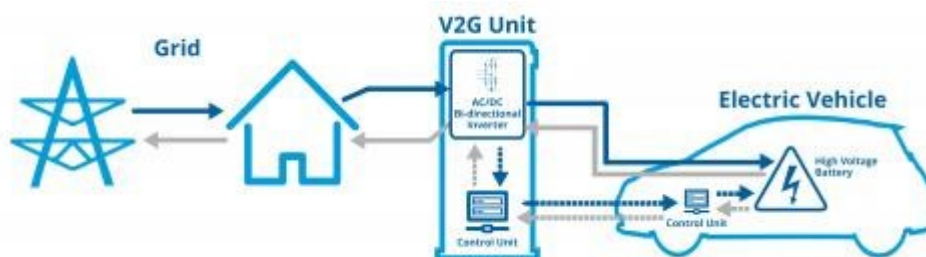
Ilustración 5. Esquema tecnología V2G
