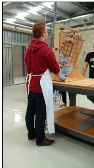
Ilustración 10: Fase de giro en máquina de rotomoldeo. FUENTE:Elaboración propia
