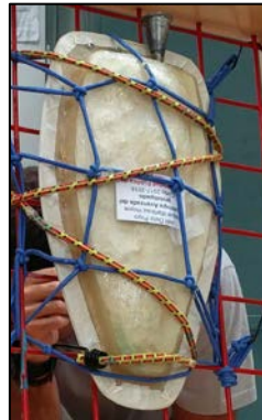
Ilustración 7: Ejemplo anclaje del molde a la estación. FUENTE: Elaboración propia.
