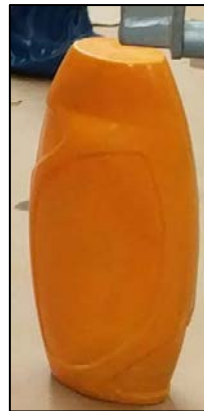
Ilustración 10: Envase hueco realizado por rotomoldeo. FUENTE: Elaboración propia
