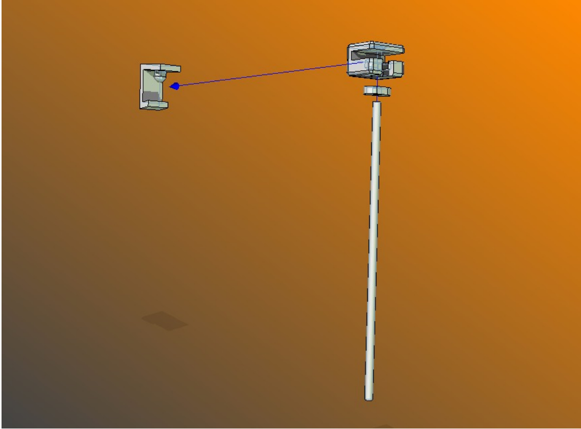
Figura 3.2.1: Esquema y piezas de la unión muestra-PZT
