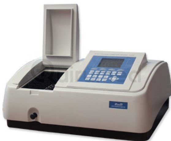
Figura 5. Espectrofotómetro para la detección de concentración de compuestos https://www.quirumed.com/es/espectrofotometro-uv-visible-modelo-4255.html
