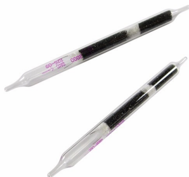
Figura 10. Tubo de carbón activo utilizado como soporte de captación en la medición https://articulo.mercadolibre.com.ar/MLA-615400058-tubos-de-carbon-activo-para-muestras-sk-cod-226-01- _JM?quantity=1
