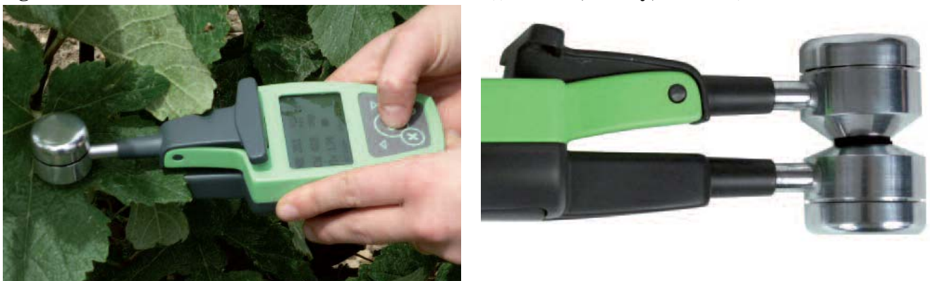
Figura 12: Detalle del medidor de clorofila Dualex ((Force-A, Orsay, Francia)
