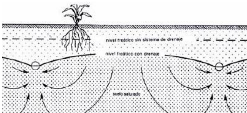
Imagen 3. Funcionamiento de un drenaje sub-superficial de tuberías
