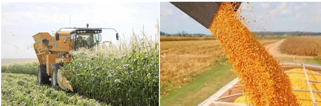
Imagen 1. Cosechadora de maíz dulce a la izquierda y descarga de cosechadora de maíz seco en grano a la derecha.
