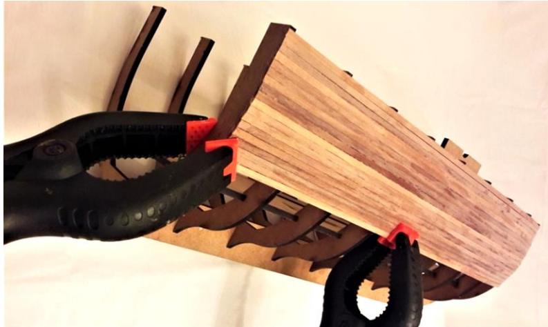
Ilustración 72: Proceso de unión del forro del casco
