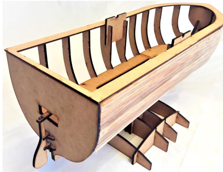
Ilustración 74: Ensamblaje de tapas en el esqueleto
