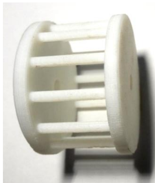
Ilustración 21: Jaula central en impresión 3D
