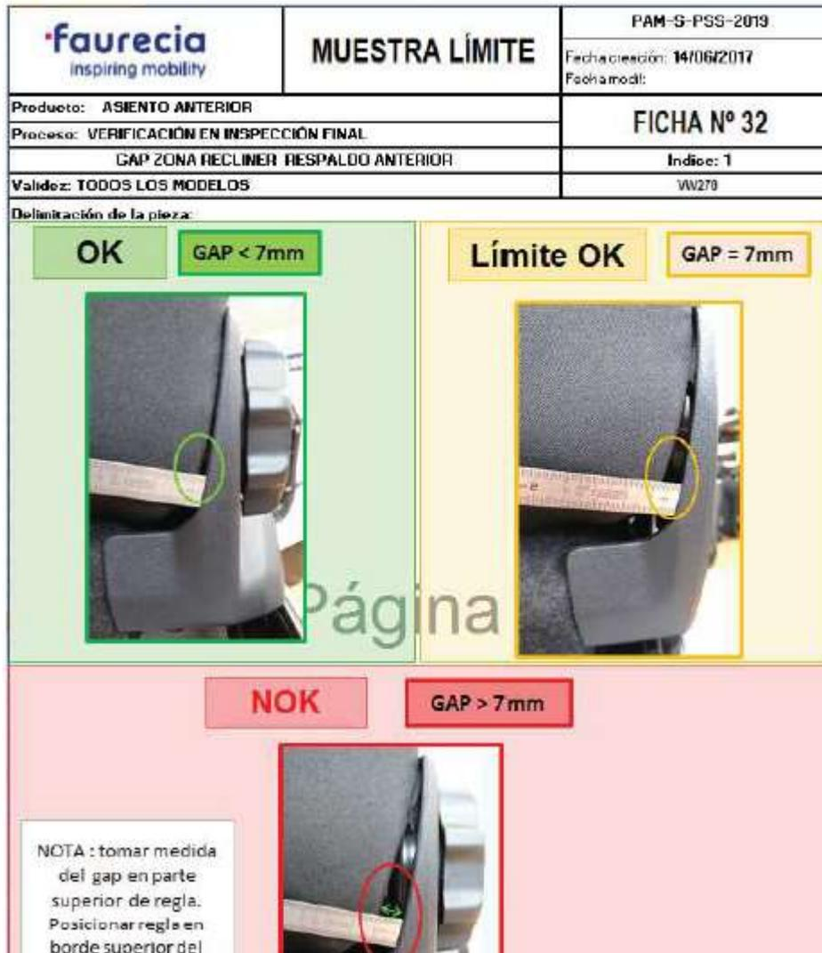
Ilustración 56 Ejemplo catálogo de defectos.
