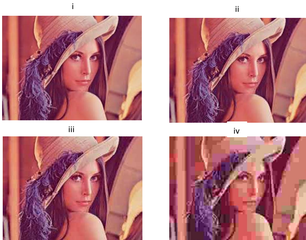
Figura 6: Ilustración de la imagen Lena decodificada con diferentes bitrates: (i) imagen original, (ii) ratio de compresión de 60 obteniendo una PSNR de 33.9735 dB, (iii) ratio de compresión de 30 obteniendo una PSNR de 30.3385 dB, y (iv) ratio de compresión de 5 obteniendo una PSNR de 22.9062 dB.
