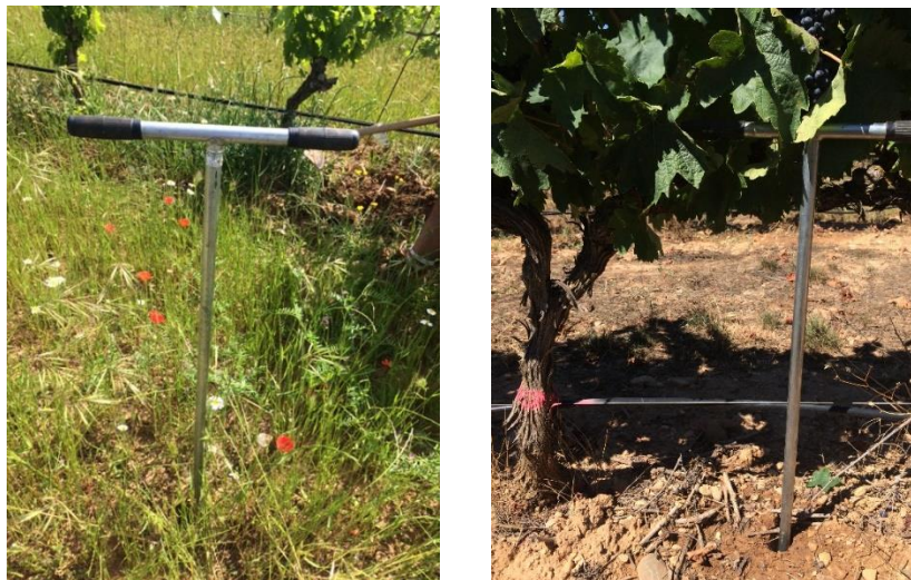
Figura 4.- Recogida de muestra de suelo con barrena en la calle y en el cordón.
