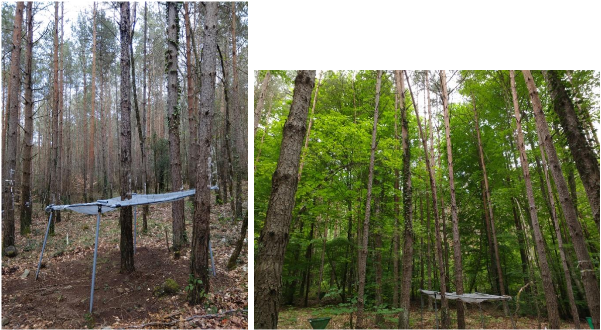
Figura 13: Malla de retención del tratamiento C, para evitar que el desfronde cayese al suelo
