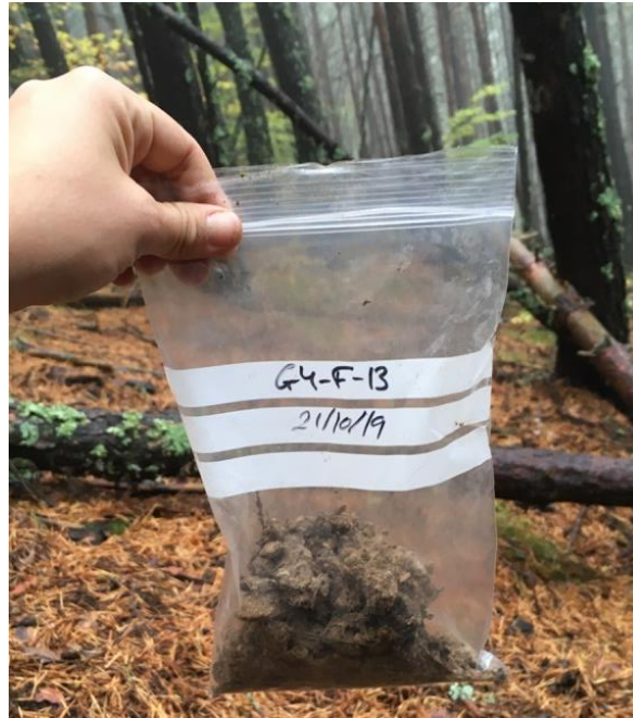
Figura 15: Muestra recogida en Garde, la nomenclatura etiquetada significa lo siguiente, G (Garde), 4 (Nº de parcela), F (Fertilizado), 13 (profundidad 13 cm).
