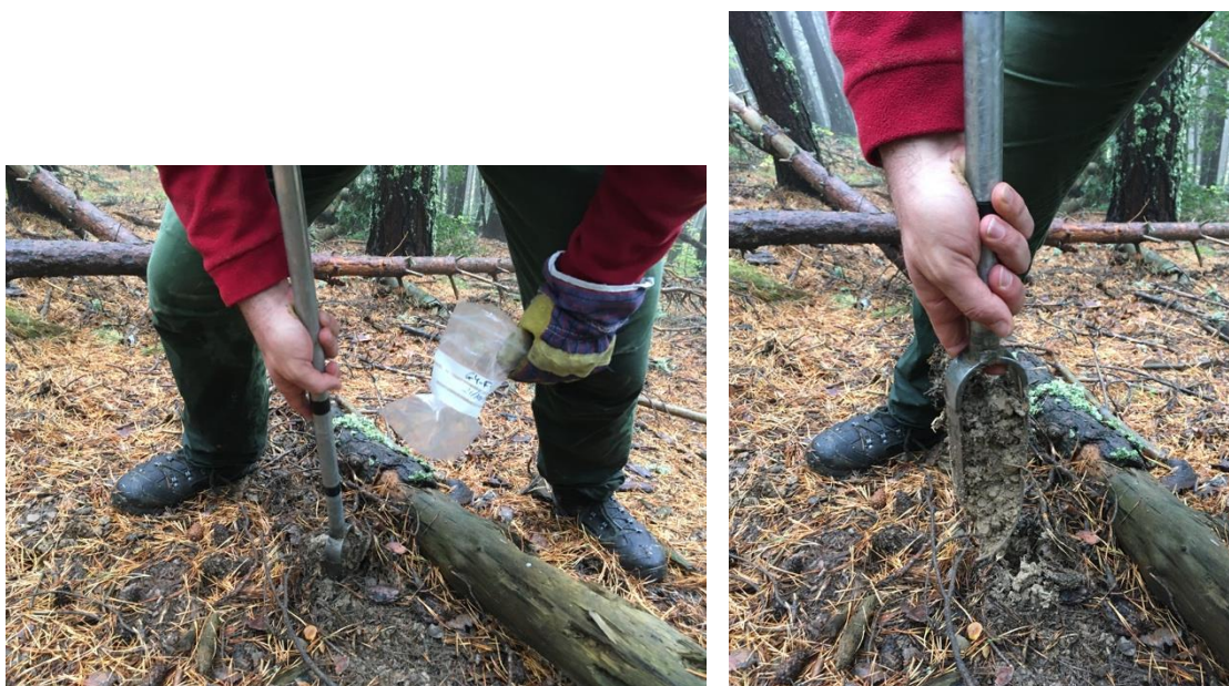
Figura 14: Extracción de muestras con una barrena en las parcelas de estudio de la localidad de Garde
