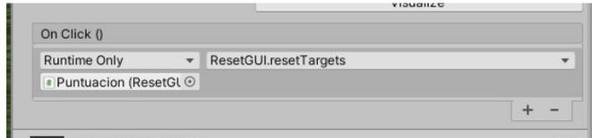
De este modo estamos indicando que la **acción de hacer clic** en el botón **activa la función resetTargets()** contenida en el script "ResetGUI.cs" incluido en el objeto puntuación.
