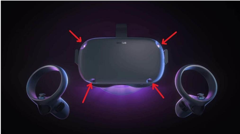
Imagen de las **Oculus Quest**, las flechas indican las cuatro cámaras laterales que enfocan directamente hacia el campo visual del usuario.
