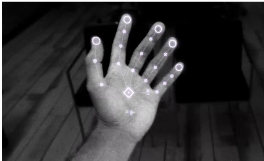
La función de **Oculus** de “**Hand tracking**”, permite usar tus manos como controladores, siendo estas monitorizadas usando las cámaras integradas del propio visor.
