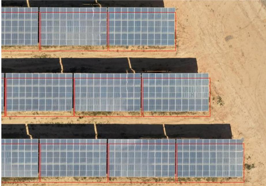
*Figura 81: Detalle del plano corregido de las mesas de la planta de Teruel superpuesto sobre una ortofoto distinta de la que se ha usado para su corrección*
