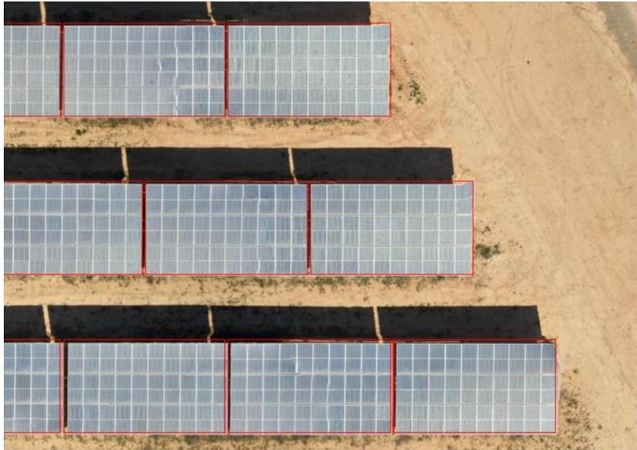
*Figura 77: Detalle de la ortofoto de la planta de Teruel con el plano de las mesas corregido superpuesto*
