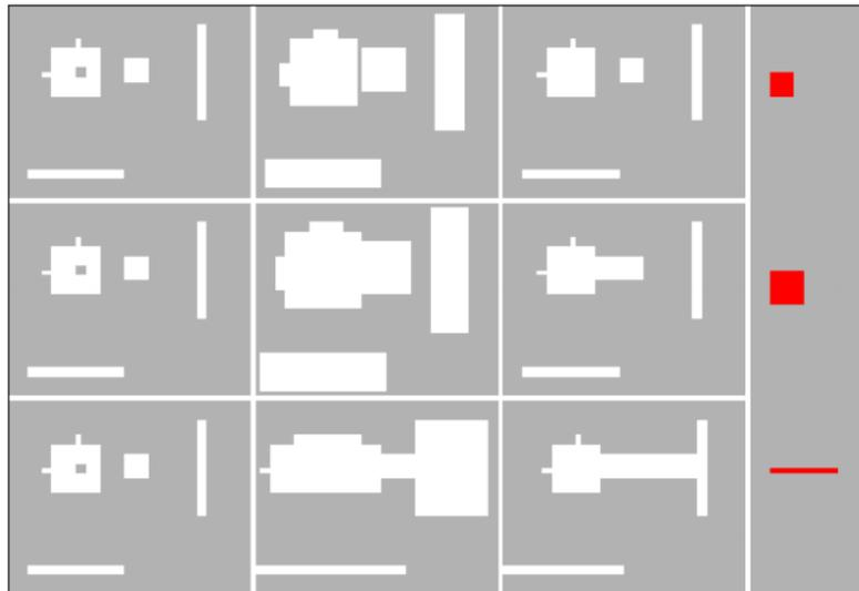
Figura 21: Ejemplo de operación morfológica de cerramiento. Primera columna: máscara inicial. Segunda columna: máscara inicial tras la dilatación. Tercera columna: máscara dilatada tras la erosión. Cuarta columna: elemento de estructuración usado
