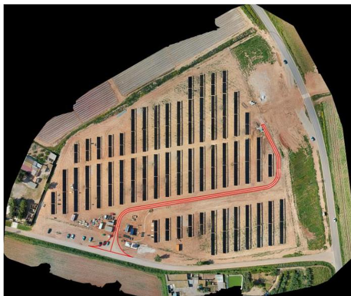
Figura 83: Ortofoto de la planta de Murcia con el plano del camino interno superpuesto.
