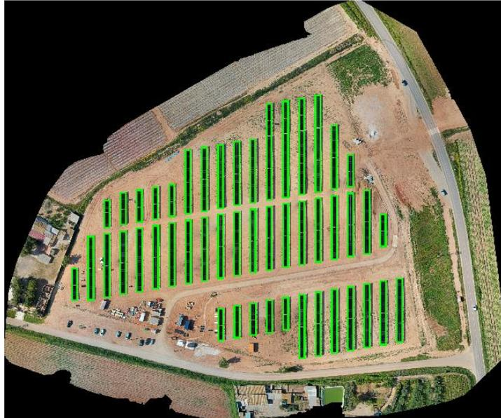
Figura 52: Ortofoto de la planta de Teruel con las filas de paneles marcadas
