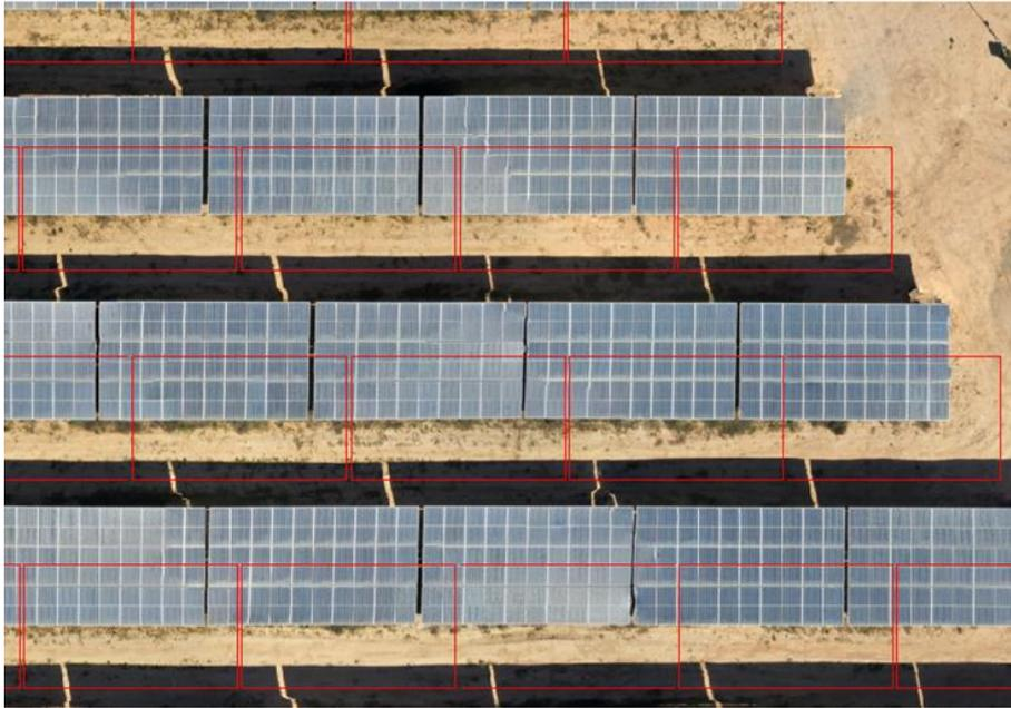
*Figura 74: Detalle de la ortofoto de la planta de Teruel con el plano de las mesas superpuesto*
