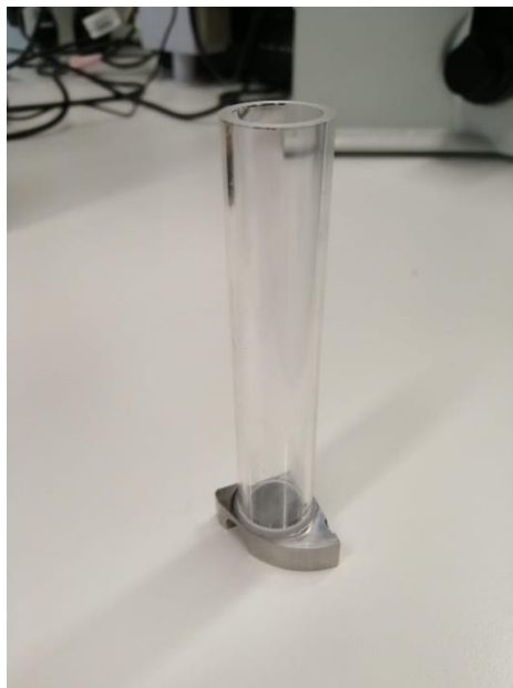
Figura 18: probeta lista para el ensayo de corrosión.
