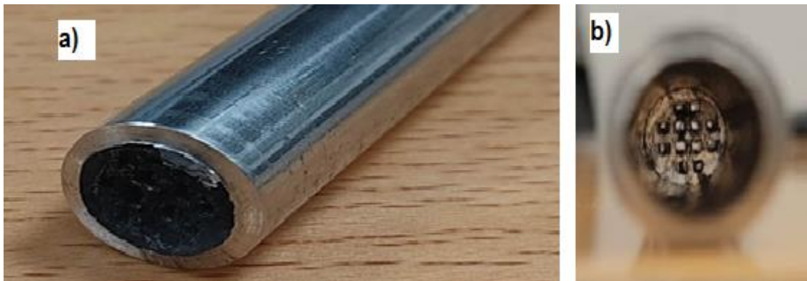
Ilustración 32: (a) Cámara con el microrreactor acoplado (b) Vista transversal de la cámara
