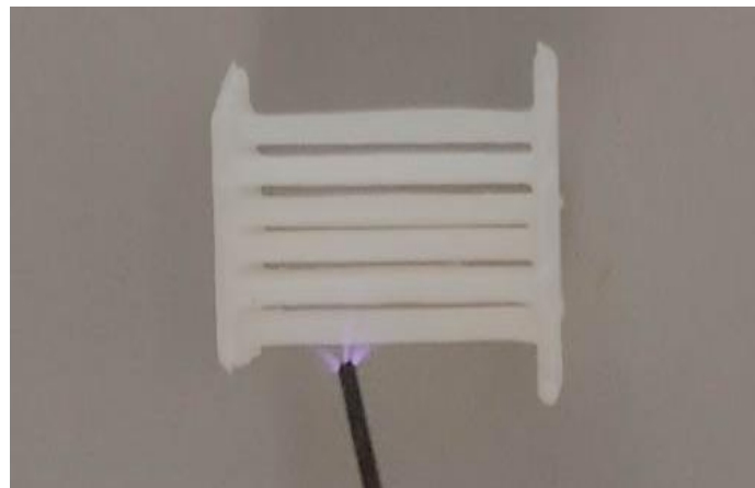
Ilustración 24: Tratamiento superficial con plasma sobre los microcanales.
