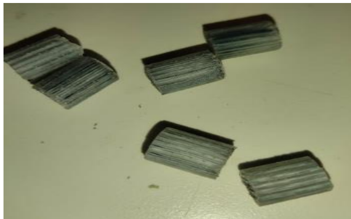
Ilustración 30: Microrreactores de PDMS, con canales de 0,8x0,8 mm, impregnados en Mo 2 C
