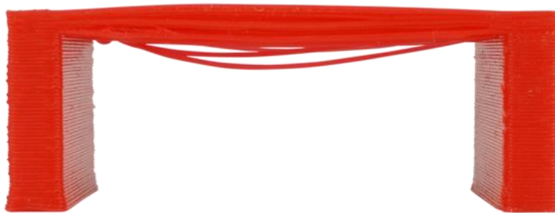
Ilustración 17: Ejemplo del efecto 'bridging'. Fuente: all3dp.com
