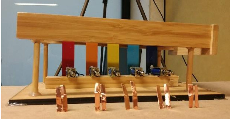
Ilustración XXXIV Xilófono con solenoides y cintas de cobre
