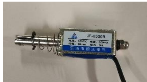
Ilustración XIV Solenoide 12V Efecto Lineal 3.7x1.5mm JF0530B
