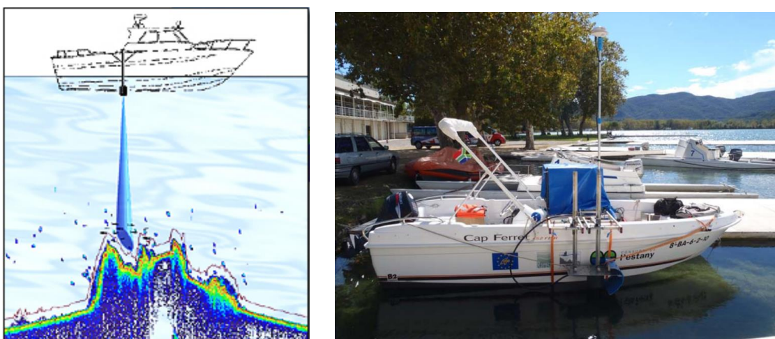
Figura 23.- Sonda de medición batimétrica (Schneider & Vidal, 2011).
