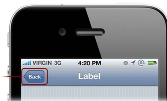
Figura 1-3-3 Navigation Bar mostrando un botón que permite navegar a la vista anterior.
