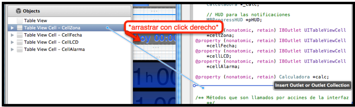
Figura 5-1-3 Añadiendo outlets automáticamente desde el Interface Builder.
