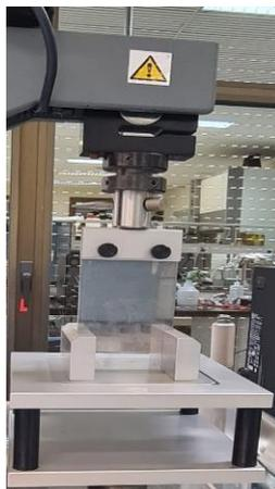
**Ilustración 15. Sonda cizallamiento, cuchilla**
