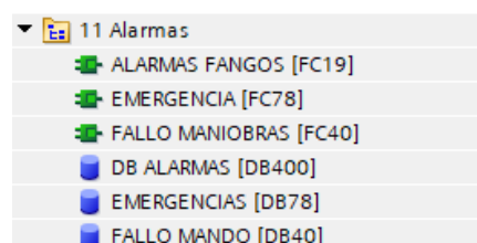
Figura 6.21: Funciones de alarma del PLC de Energía
