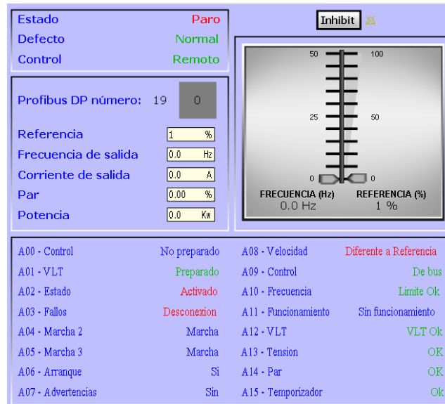
Figura 7.16: Ventana de características de un variador de frecuencia
