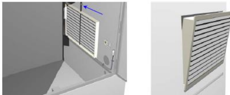
Figura 5.5: Retirada rejilla de ventilación lateral
