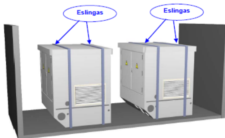
Figura 2.1: Detalle de eslingas en transporte marítimo
