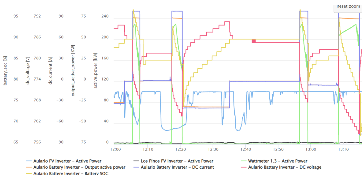
Gráfico 22: Comportamiento carga y descarga de la batería estrategia 2 (07/06)
