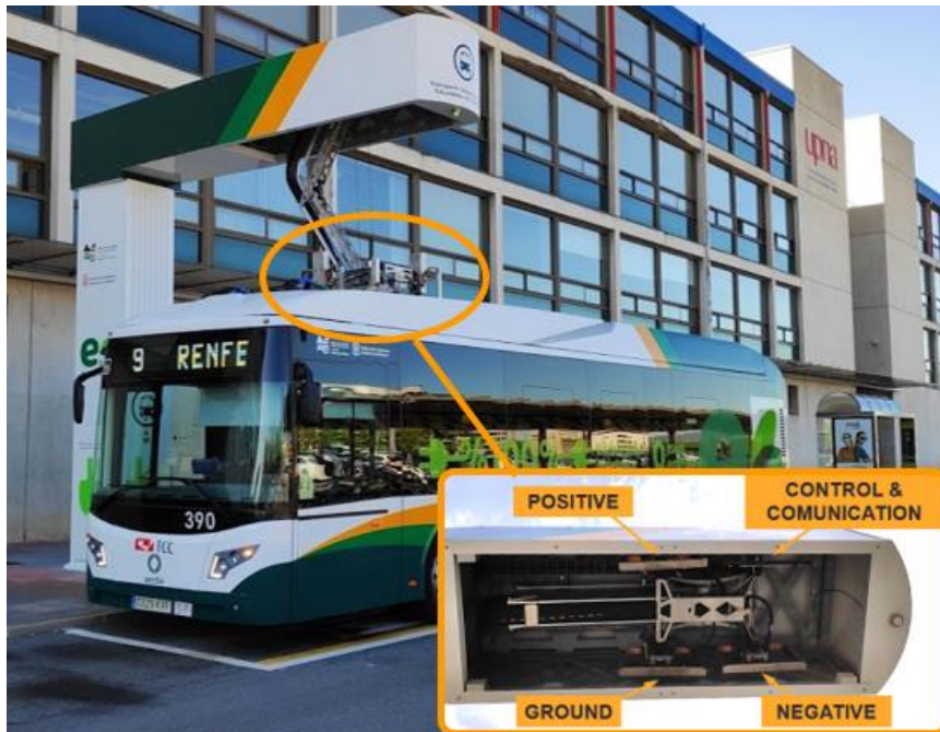
Figura 3: Funcionamiento carga conductiva [9]
