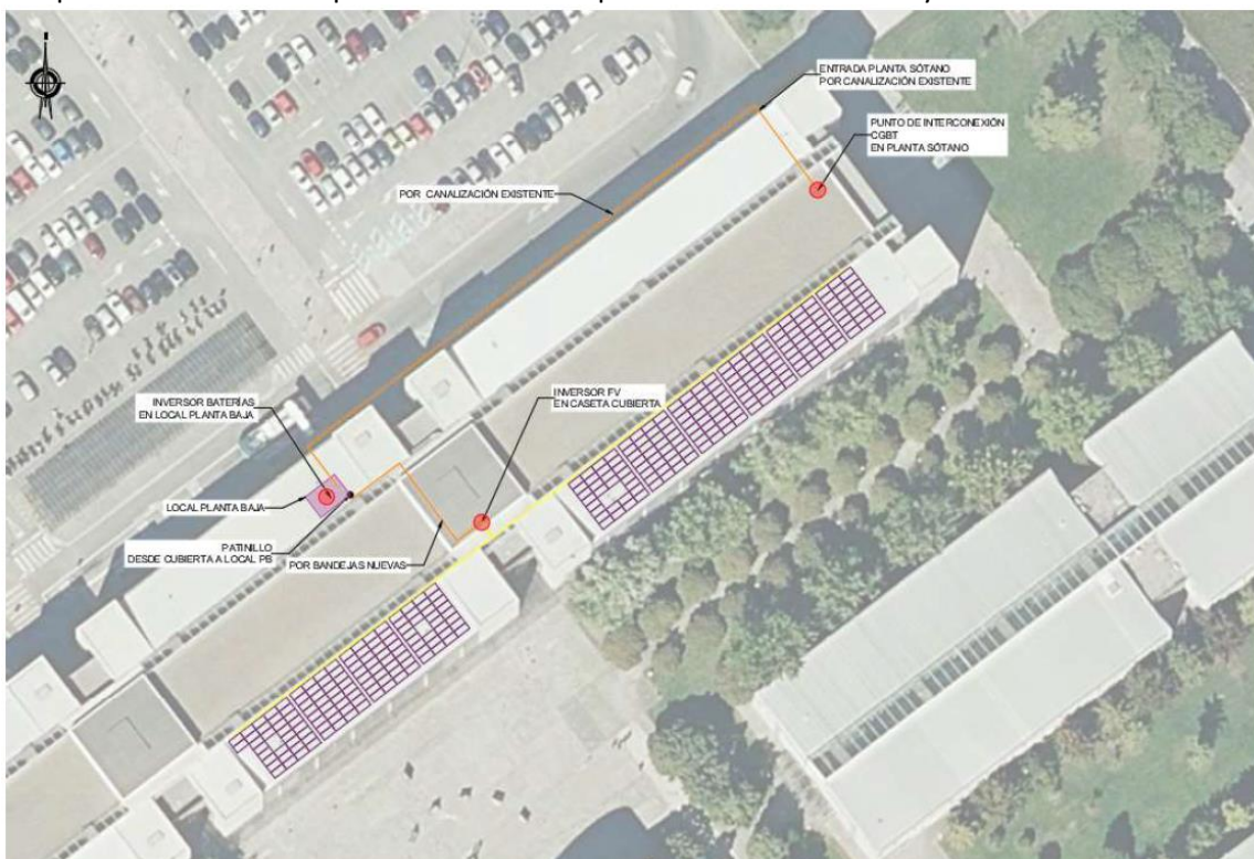
Figura 9: Microrred fotovoltaica del Aulario, UPNA [15]
