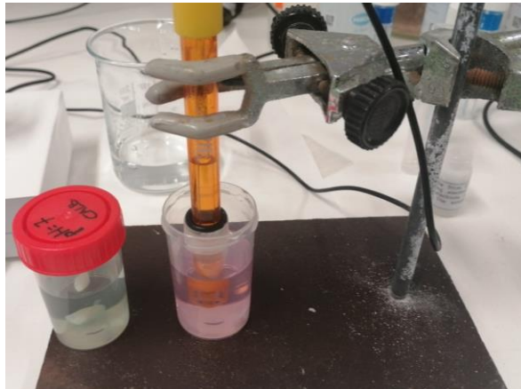
Imagen 17. Configuración del ensayo de medida de pH.
