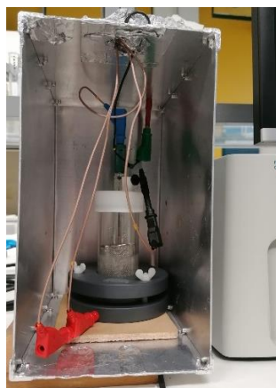
Imagen 20. Celda electroquímica configurada para el ensayo de Tafel.
